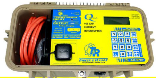
机箱内的电缆存储
